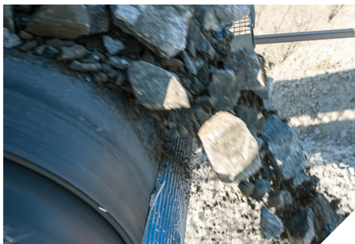
En la mayoría de los casos, el limpiador de correa primario se coloca en la polea de cabeza que es donde el material sale de la correa.
