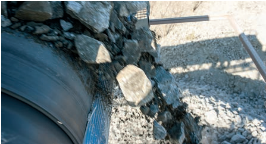
In den meisten Fällen wird der Vorabstreifer an der Kopftrommel positioniert, denn dort verlässt das Material den Gurt.
